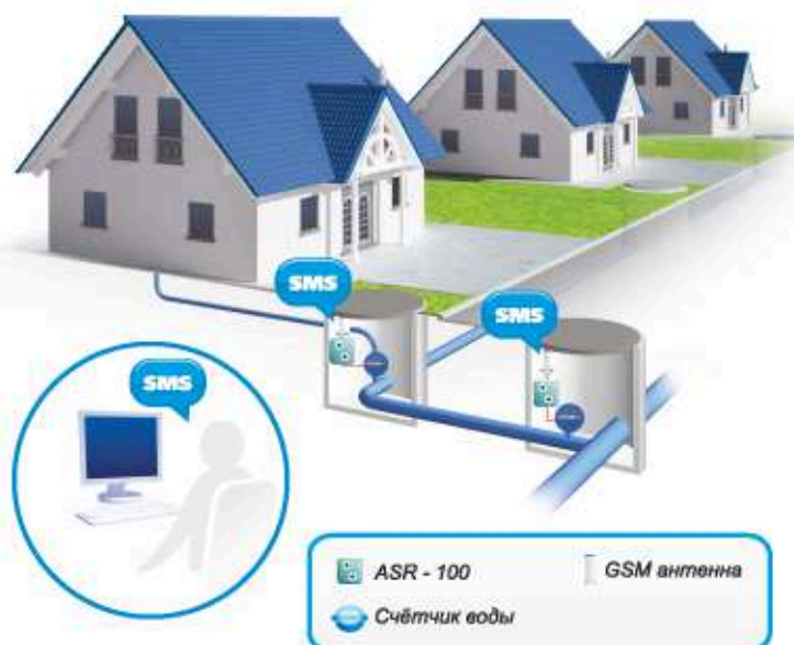
Структура системы учёта воды в частном секторе
